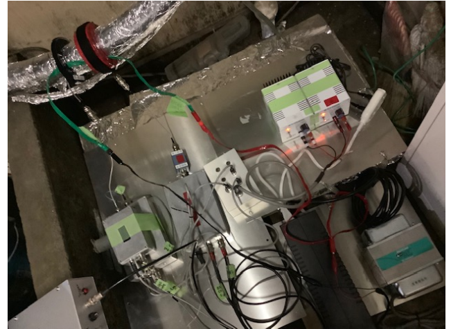
図 1 ロゴスキーコイルを用いた測定。
